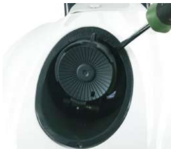
8.1: Távolítsa el propeller védőfedelét, és takarítsa le a koszt vagy haját propellerről.
