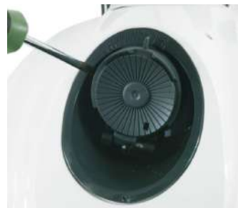
8.2: Egy lapos csavarhúzóval feszítse le a védőfedelet, ahogy az a képen látható.
