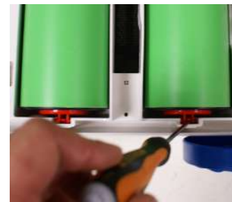
8.2: Ha a hulladék nehezen érhető el, egy lapos csavarhúzóval ideiglenesen szerelje le a görgőket. Nyomja meg a fűleket a képen látható módon.
