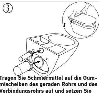
Tragen Sie Schmiermittel auf die Gummischeiben des geraden Rohrs und des Verbindungsrohrs auf und setzen Sie sie in Keramiklöcher ein.
